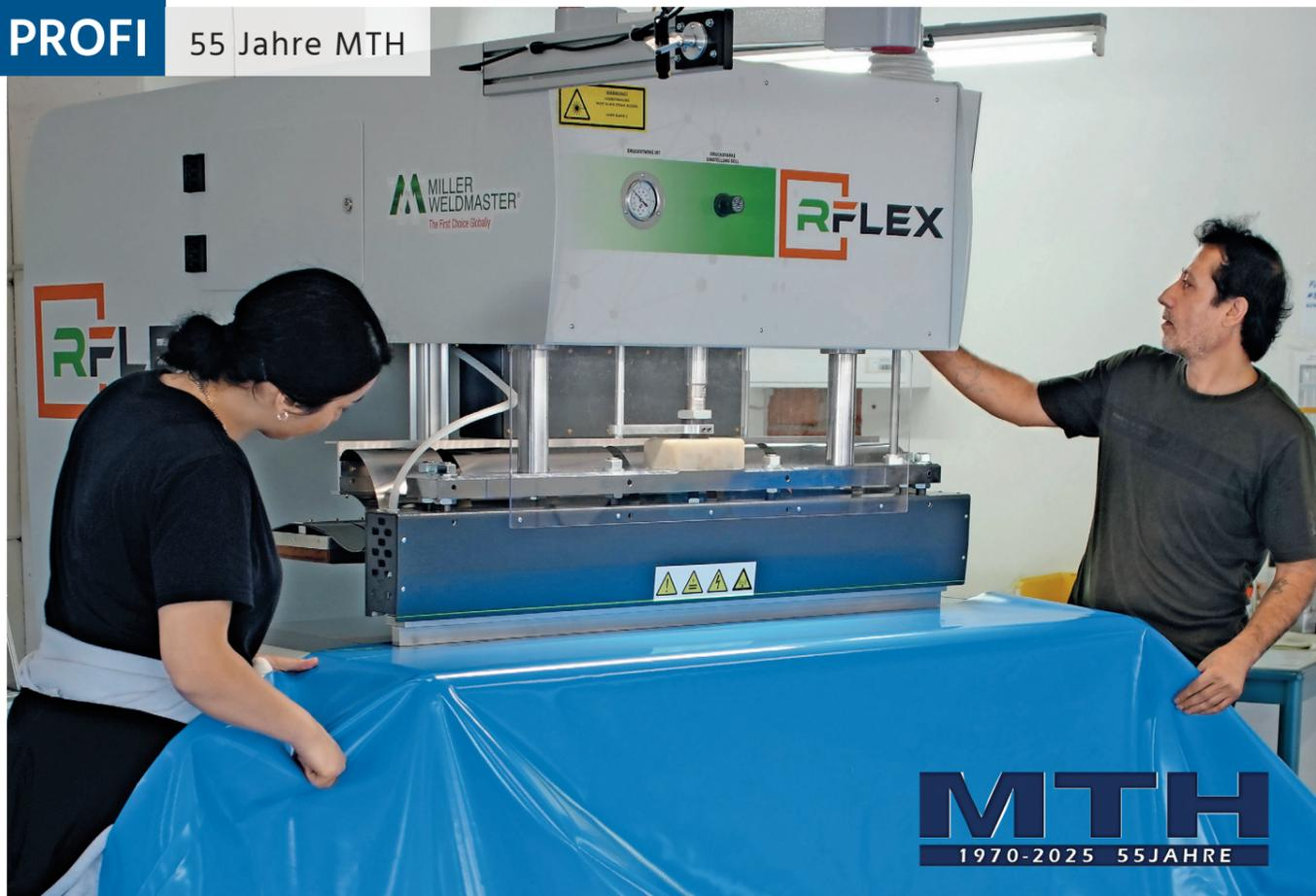
Ein Blick hinter die Kulissen der Fertigung bei MTH. Hier zu sehen ist eine Hochfrequenz-Schweißmaschine.
